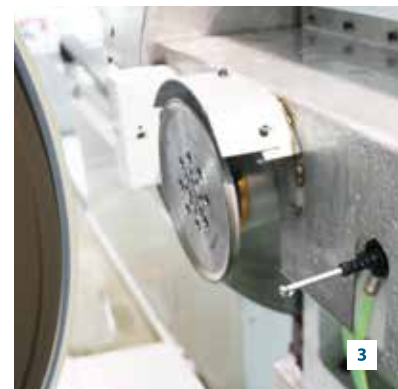
2 Internal grinding wheel dresser with single point diamond Механизм правки круга внутреннего шлифования -с одноточечным алмазом
