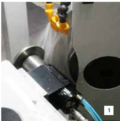
1 Diamond flarin cup wheel dresser Алмазная, расширяющаяся к низу чаша правки шлифовального круга
