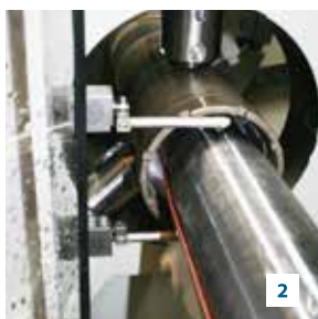
1 Absolute in-process measuring device Абсолютное измерительное устройство “в процессе”
