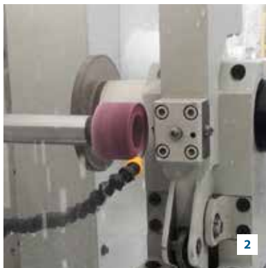
2 Internal grinding wheel dresser with single point diamond Механизм правки круга внутреннего шлифования -с одноточечным алмазом
