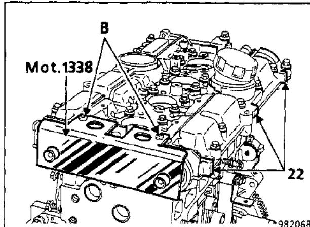
Отверните болты крепления крышки головки блока цилиндров (34 для двигателя N7Q или 40 для двигателя N7U) и сдвиньте ее вертикально легким постукиванием медной выколоткой по выступам (22), чтобы избежать повреждения кромок канавок (23) головки блока цилиндров.
