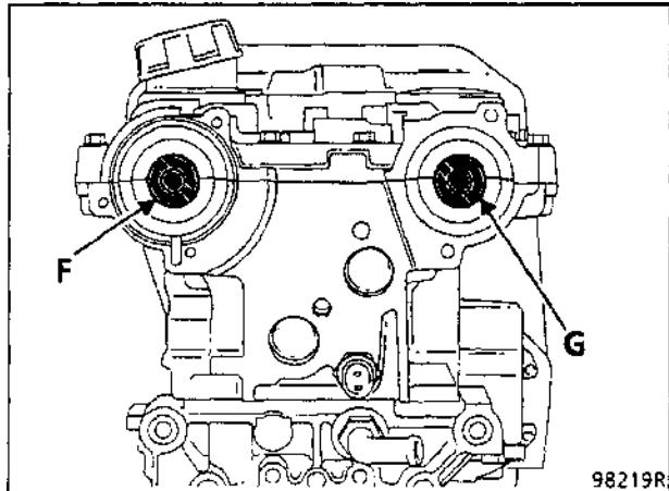
F: распределительный вал впускных клапанов
