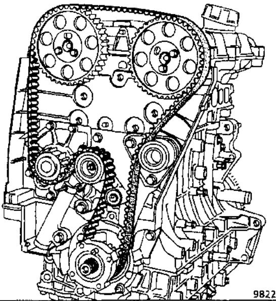
Резко выньте штифт натяжного устройства зубчатого ремня.
