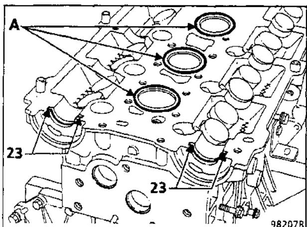
Снимите круглые уплотнительные кольца (A) гнезд свечей зажигания.
