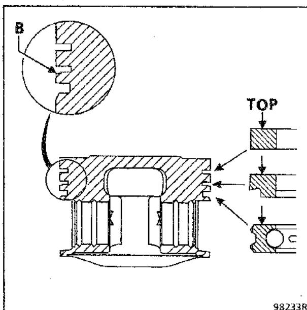
Вырез (B) в поршне обеспечивает образование масляной пленки, что способствует улучшению уплотнения вторым кольцом.
