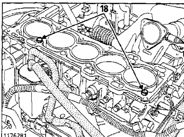
**Все болты крепления головки блока цилиндров должны обязательно заменяться после снятия, а резьба и поверхность под головками болтов должны смазываться моторным маслом.**
