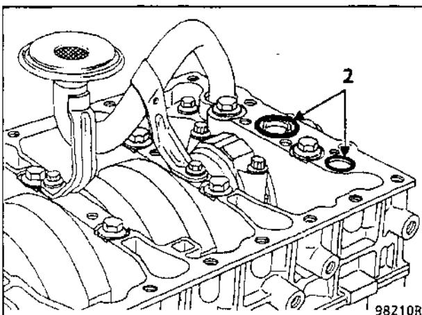
**ПРИМЕЧАНИЕ.** Необходимо обратить внимание на расположение на одинаковом уровне картера крышек коренных подшипников и поддона картера со стороны маховика, чтобы предупредить деформацию картера сцепления при его сборке с коробкой передач.
