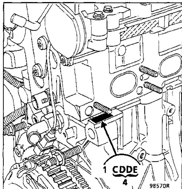
**ПРИМЕЧАНИЕ.** Номером 1 обозначен поршень первого цилиндра, который расположен **со стороны газораспределительного механизма**.
