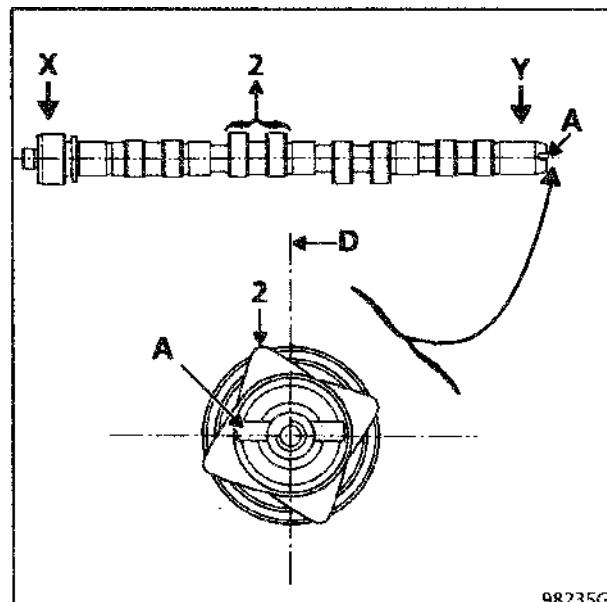
Расположите прорезь (A) на торце распределительного вала горизонтально (прорезь находится выше оси распределительного вала). Кулачки цилиндра (2) должны расположиться слева от вертикальной оси (D).
