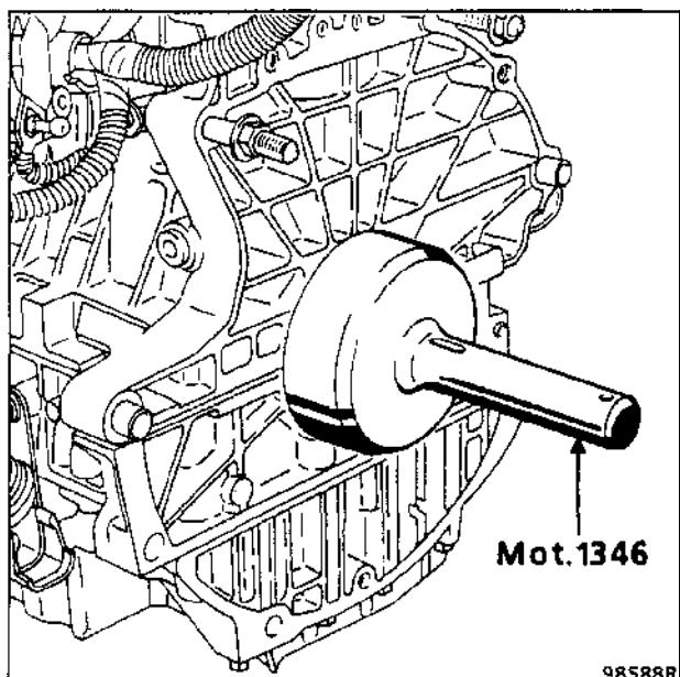
**ПРИМЕЧАНИЕ.** Приспособление Mot. 1346 устанавливается определенным образом: отверстие (1) должно расположиться против индекса на коленчатом валу.
