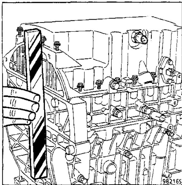
Затяните болты крепления поддона картера с моментом **17 Н·м**.
