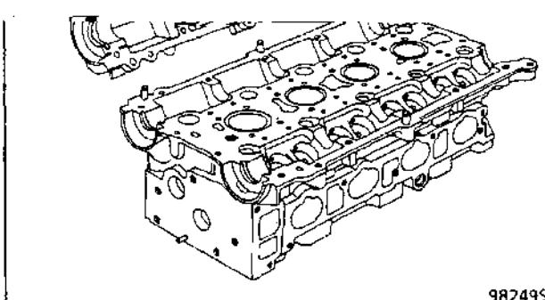
Установите распределительные валы впускных и выпускных клапанов на соответствующие им места на крышке головки блока цилиндров.
