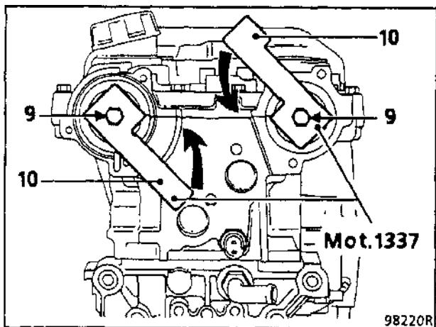
Поворачивайте распределительный вал впускных клапанов с помощью приспособления Mot. 799-01 до тех пор, пока рычаг (10) приспособления Mot. 1337 не займет горизонтальное положения.
