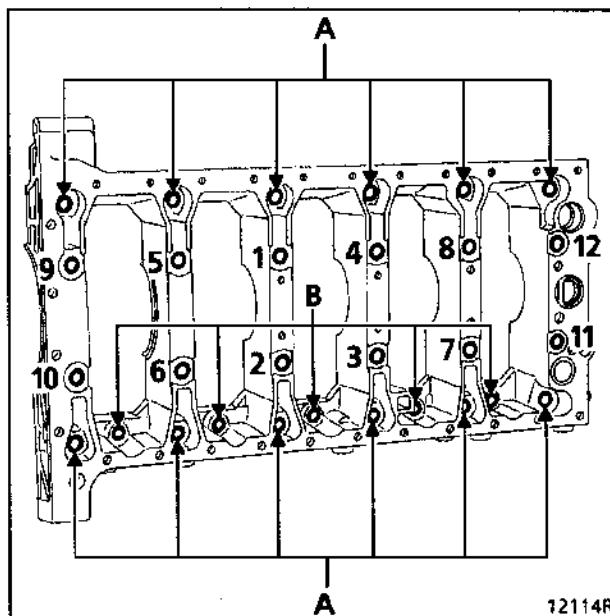
Затяните болты (A) диаметром **8 мм** с моментом **25 Н·м**.
