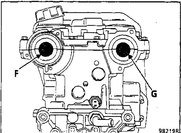
F : распределительный вал впускных клапанов
