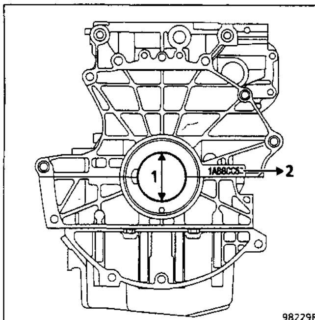
Метки 1 и 5 (двигатель **N7Q**), 1 и W (двигатель **N7U**) означают, что первый подшипник имеет **маркировку А** со стороны механизма газораспределения, а последний подшипник имеет **маркировку С** со стороны маховика.
